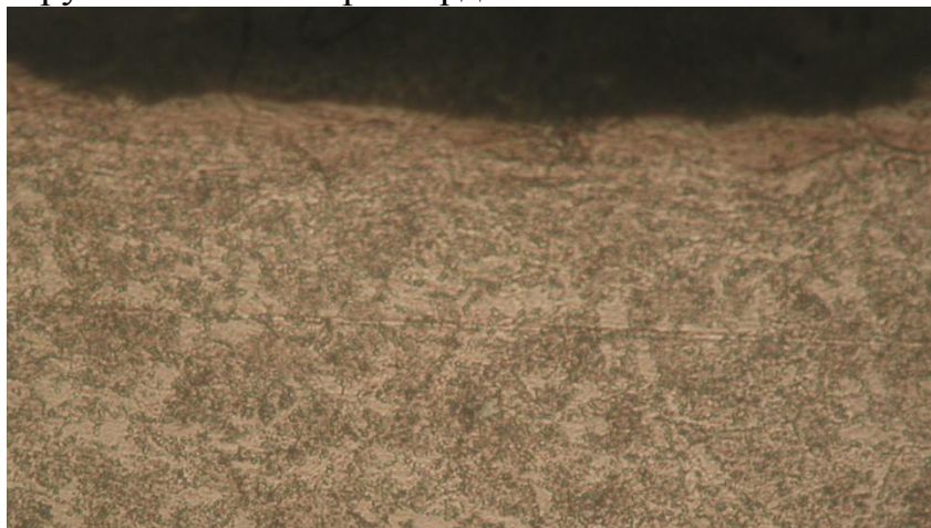
Рис. 2. Мікроструктура сталі 30 ХГСА після пластичного деформування (збільшення \times 320 ).
