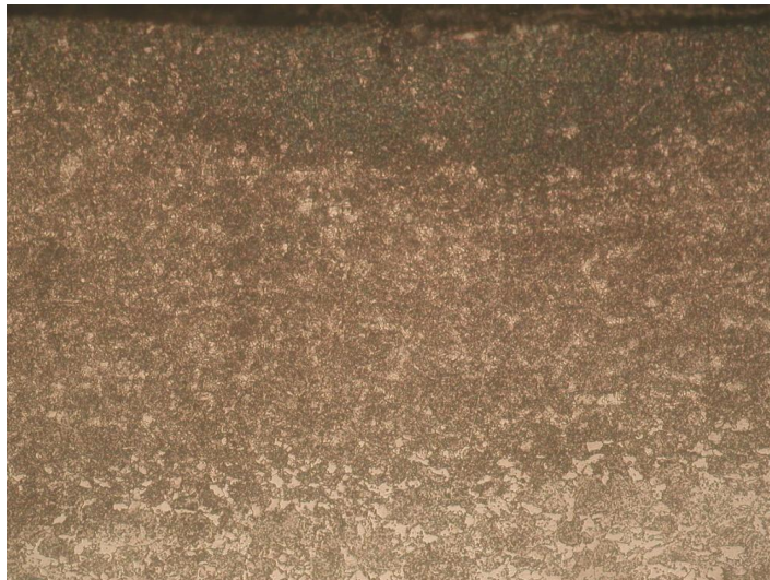
Рис. 3. Мікроструктура сталі 30 ХГСА після комбінованого термодформаційного зміцнення (збільшення ×320).
