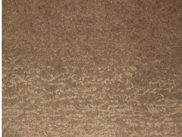
Рис. 3. Мікроструктура сталі 30 ХГСА після термообробки (збільшення×320).
