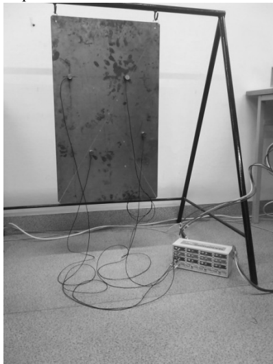
Рис. 1. Стальная пластина с закрепленными датчиками АЭ
