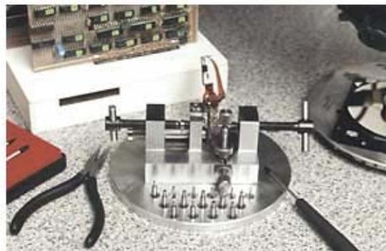
**Рисунок 1 – Слева – рабочее место по ремонту дисков в чистой комнате, справа – прецизионная установка для замены головок**
