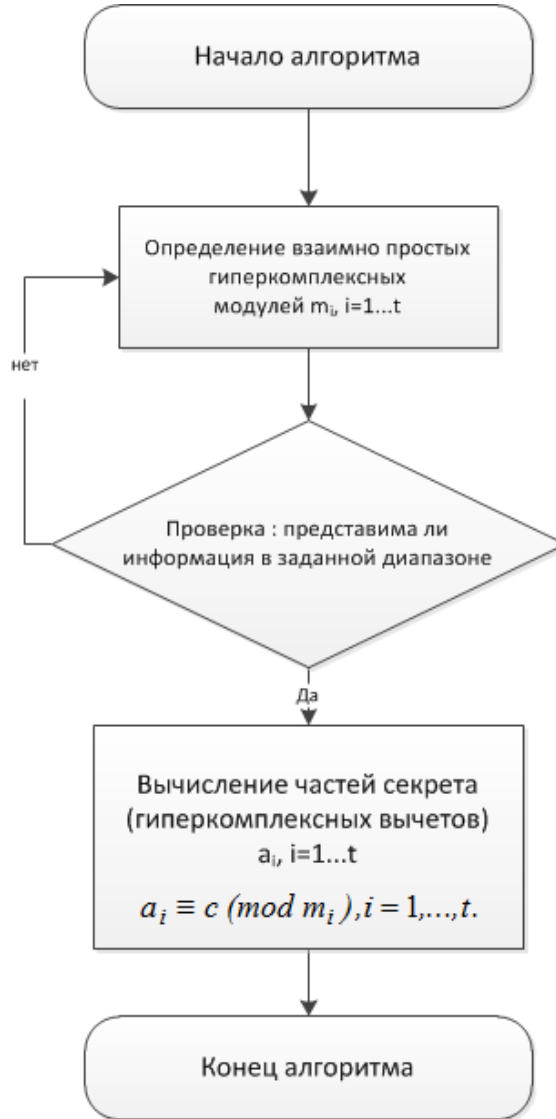
Рис. 4.1. Блок-схема алгоритма разделения секрета
