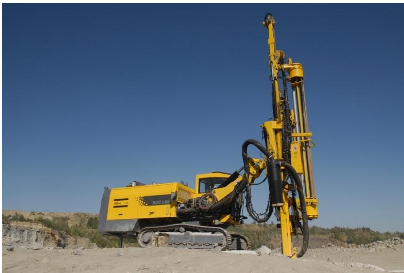
Рисунок 5.2 – Бурова установка ROC-L6H
