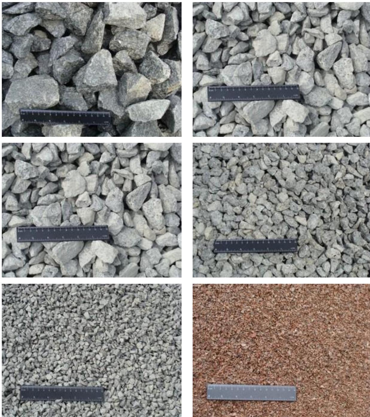
Рисунок 5.1 – Виготовлений ПАТ «Малинський каменедробильний завод» щебінь фракцій: 40-70, 25-60, 20-40, 5-20, 5-10 і 2-5
