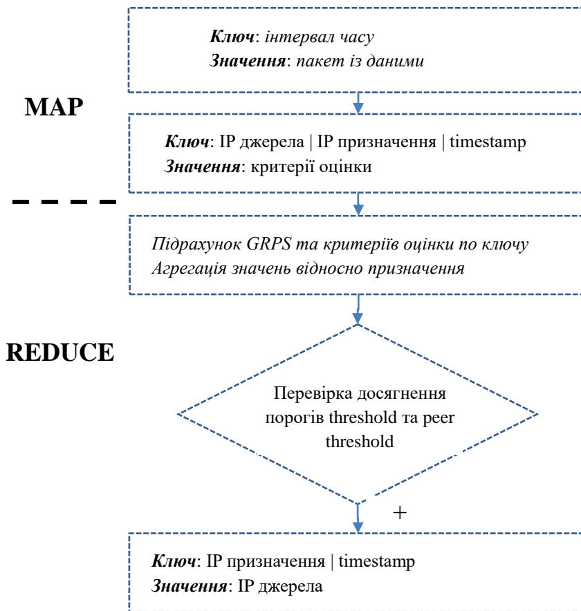
Рисунок 4 – Алгоритм виявлення атаки типу HTTP GET flood із застосуванням моделі MapReduce
