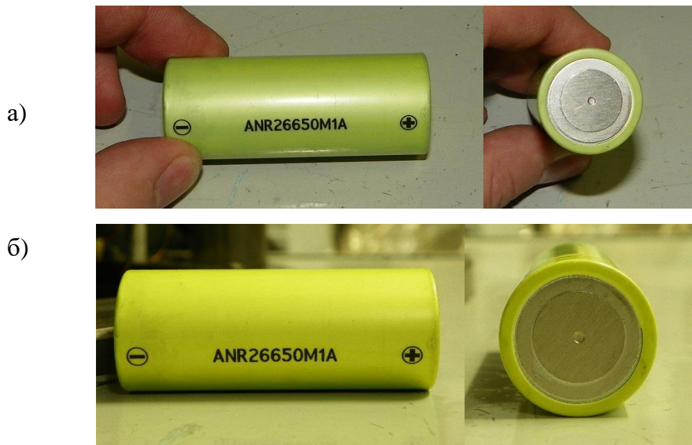
Рис. 5.5. Зовнішній вигляд Li-Fe АКБ до (а) і після (б) термовакуумних випробувань.
