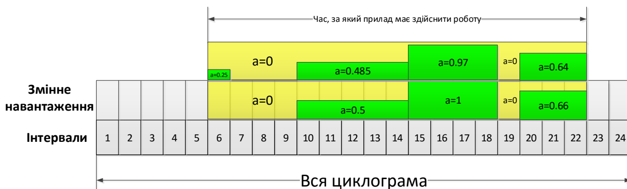
Рис. 4.3. Приклад ітераційної почергової зміни та перерахунку коефіцієнтів a для задачі, яка може працювати на певний відсоток від своєї максимальної потужності.
