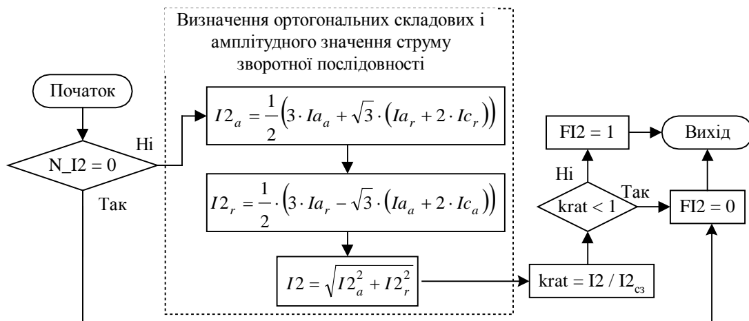
Рис. 2.6 Алгоритм перевірки умов пуску захисту по струму оберненої послідовності PRE_I2
