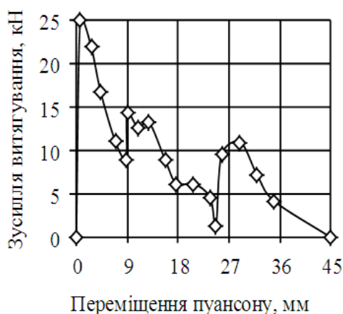
Рис. 9. Залежність зусилля витягування від переміщення пуансону
