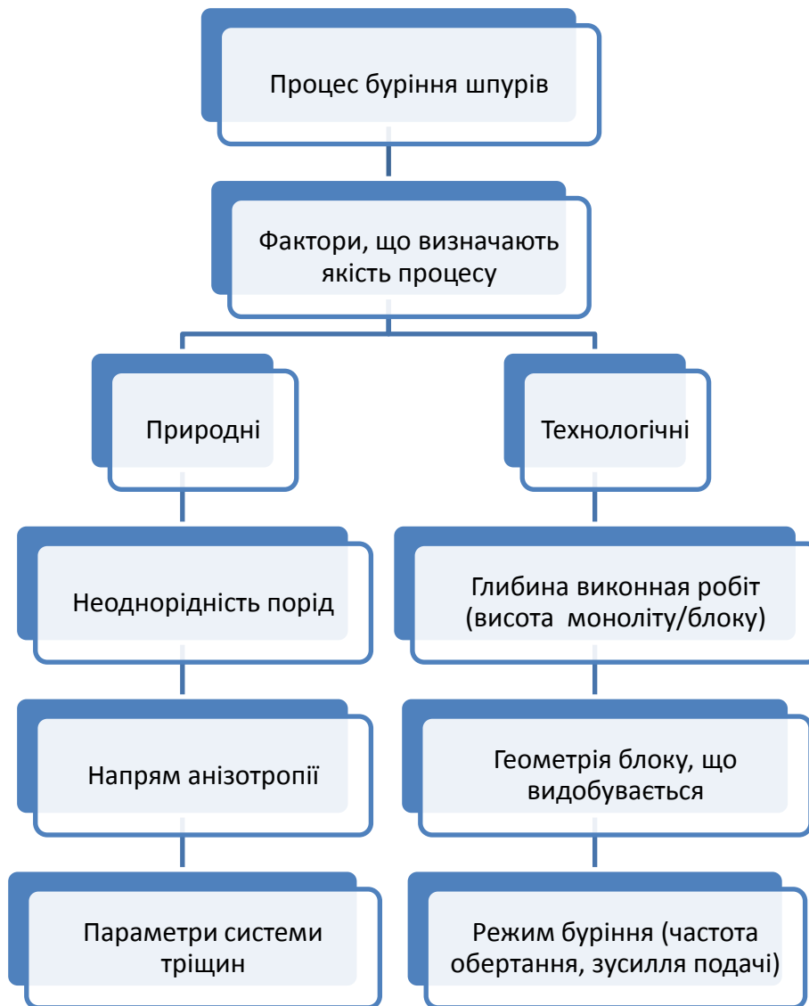
Рис. 2.4. Узагальнена схема розподілу факторів, що визначають якість бурових робіт при видобуванні декоративного каменю
