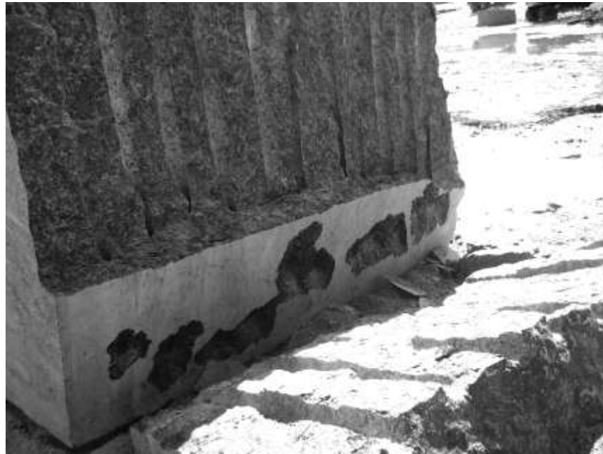
Рис 3.1. Утворення «сходинки» на бічній поверхні блоку лабрадориту при шпуровому способі пасирування
