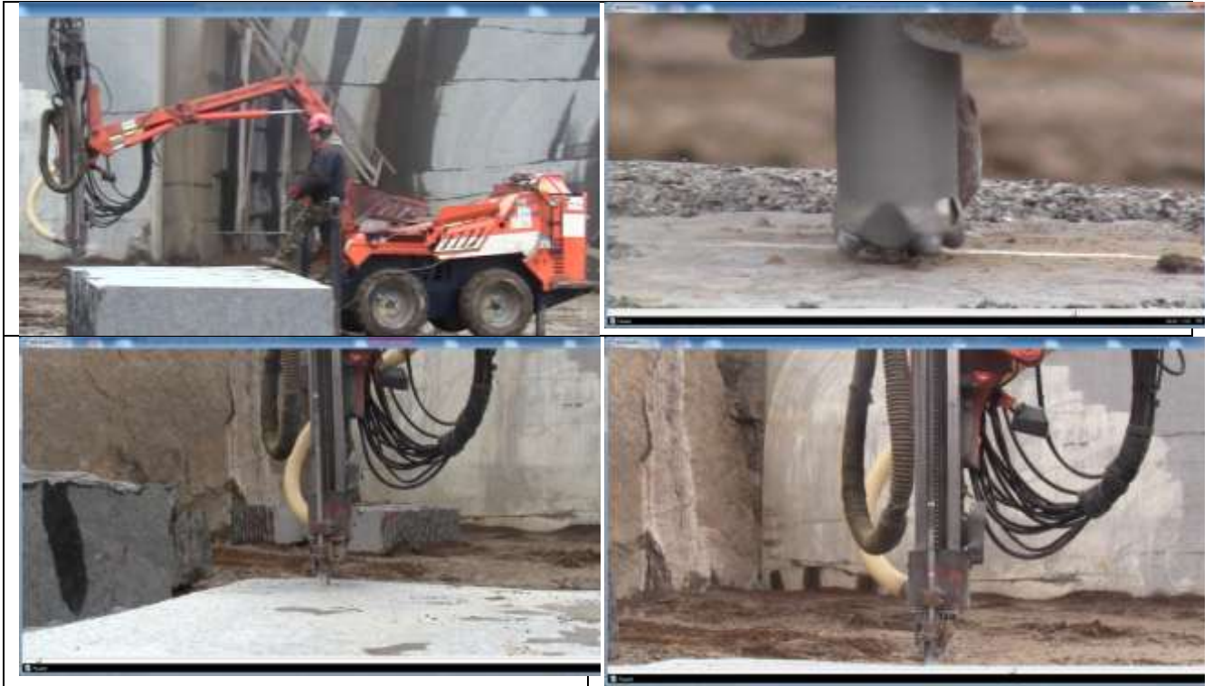
Рис.4.10. Хронометраж процесу буріння шпурів
