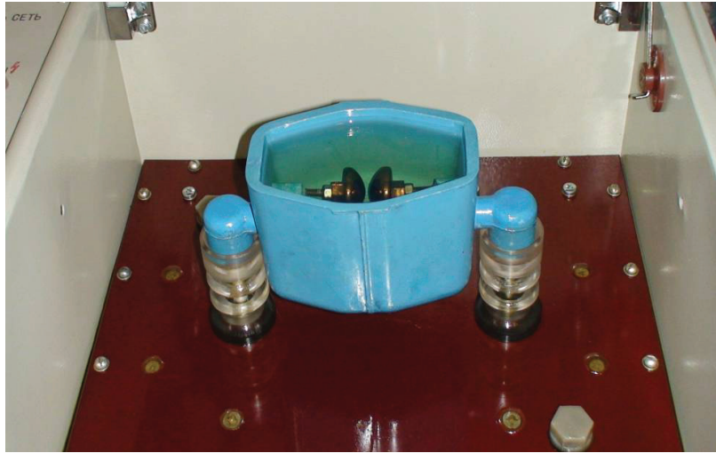
Фото 4.1. Посудина з електродами для випробувань проб масла
