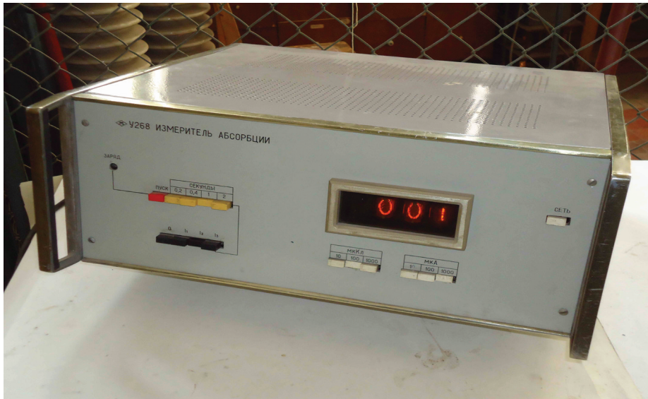
Фото 3.1. Зовнішній вигляд приладу для вимірювання струмів абсорбції У-268
