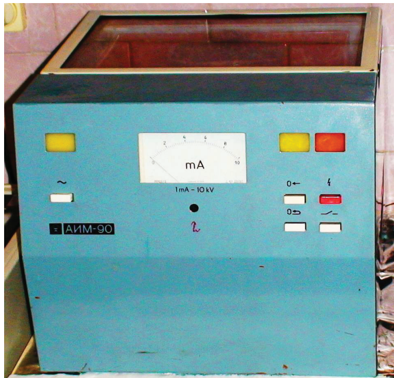
Фото 4.2. Апарат АИМ-90 для визначення пробивної напруги масла
