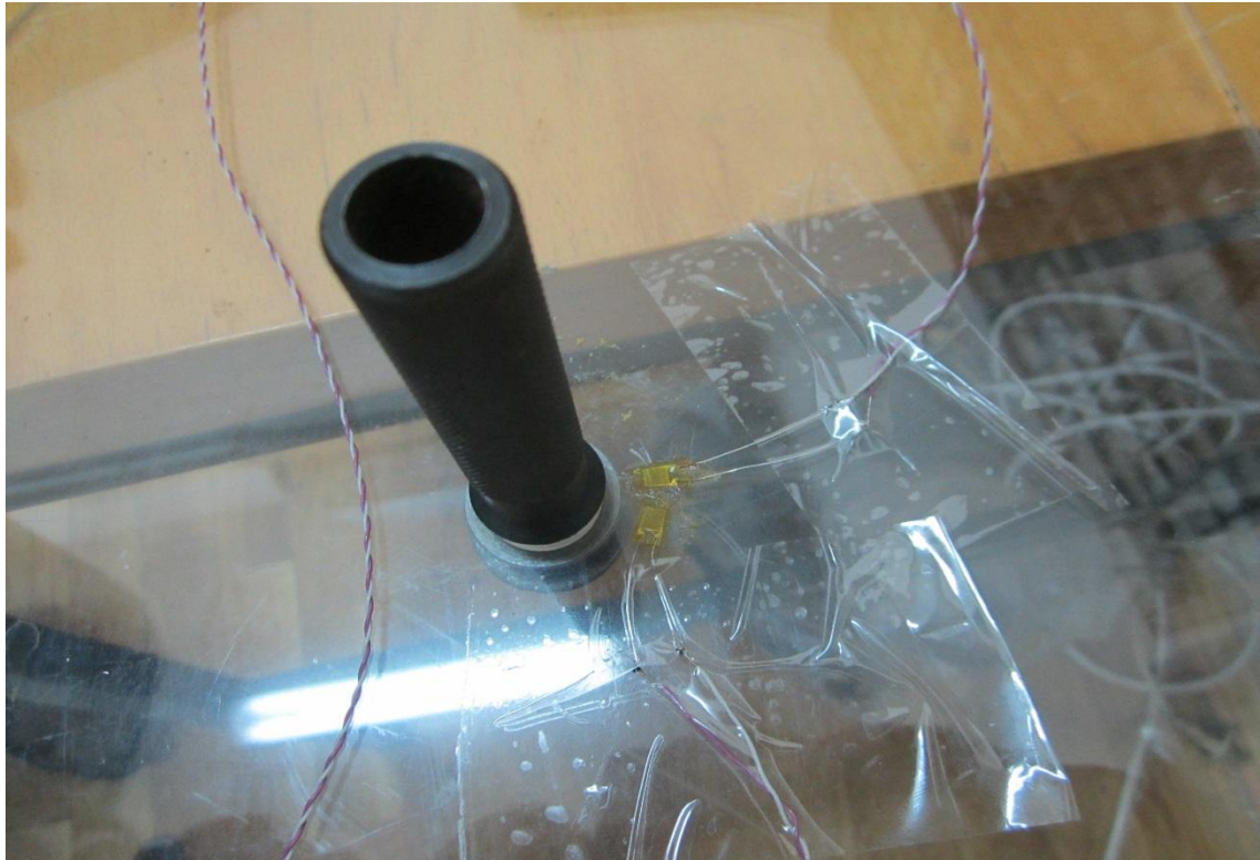
Рис. 4.4 Тензодатчики і встановлений навантажувальний пристрій.
