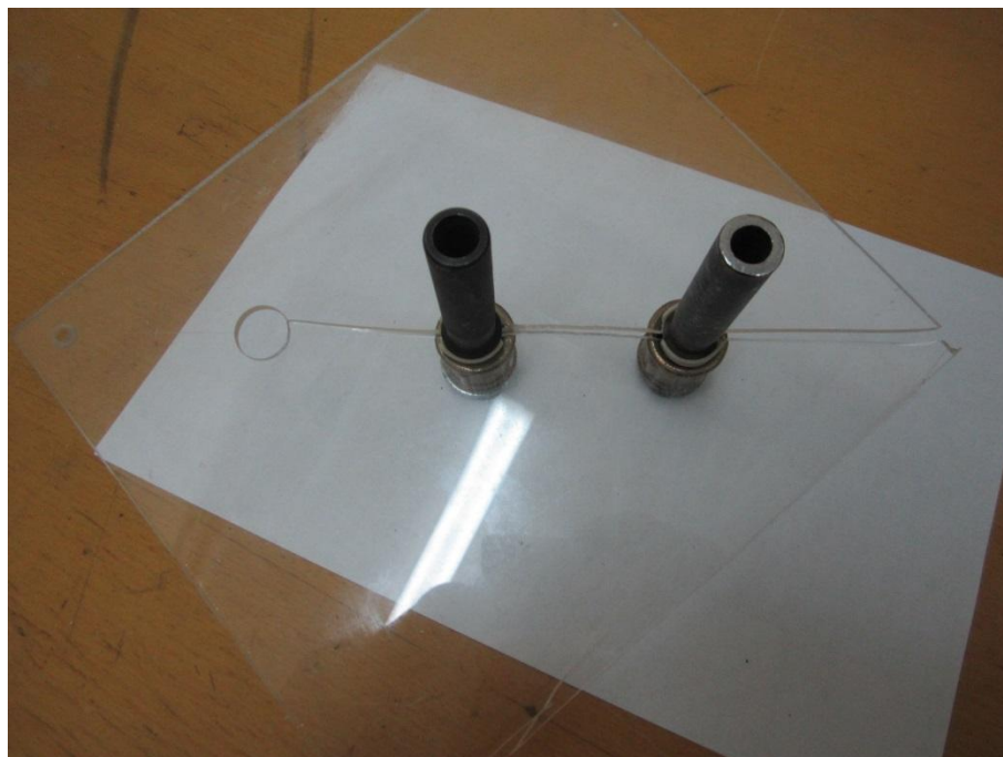
Рис. 4.9. Характер розповсюдження тріщини при штучній концентрації напружень.
