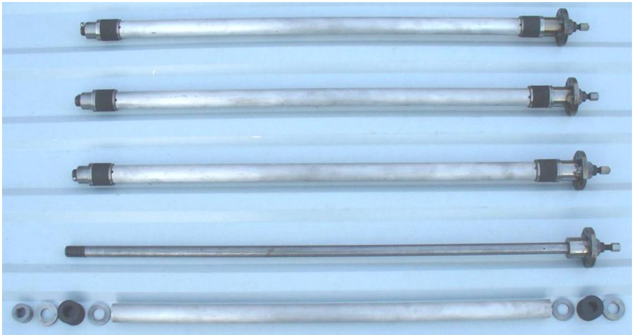
Рис. 1.9. Загальний вигляд комплекту агрегатів з розривним зусиллям по 2500кН кожний.
