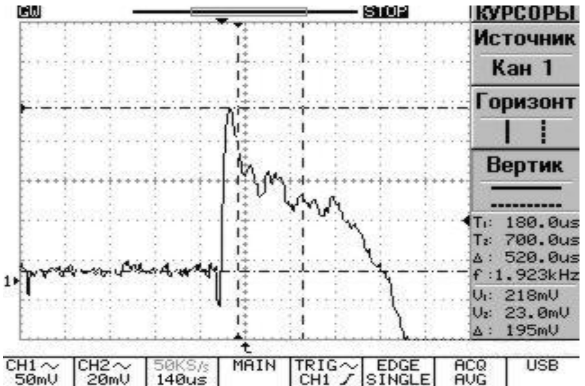
Рис. 4.37. Залежність \varepsilon_r^d(t) при дії кульки вагою 0,0497 кг при вільному контурі отвору.
