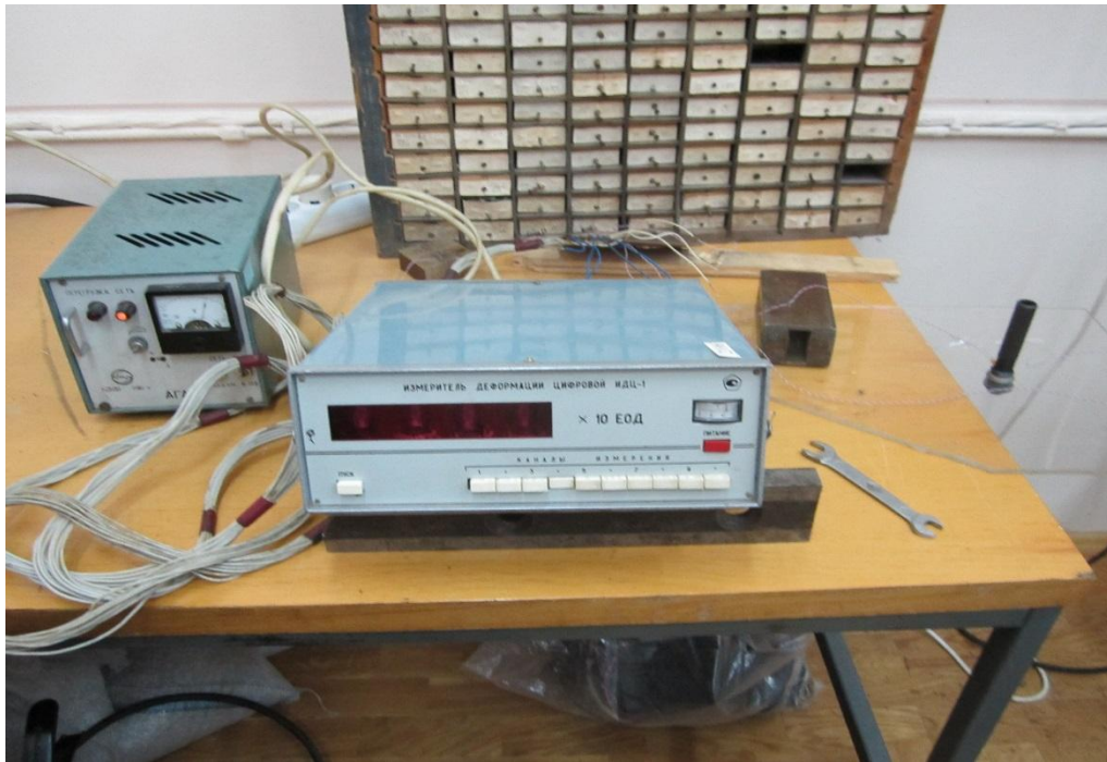
Рис. 4.5. Установа для дослідження статичних деформацій.
