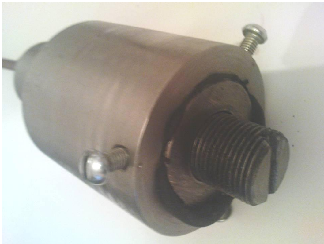
Рис. 1.12. Видавлювання ущільнення через зазор 0,8мм.
