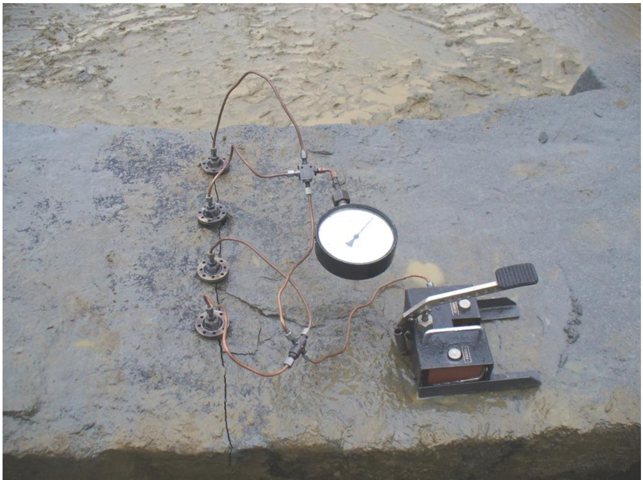
Рис. 4.25. Тріщиноутворення в шпурах блоку в кінці першого етапу технологічного процесу.
