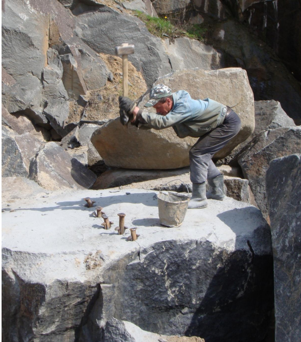
Рис. 1.2. Розкол гранітного блоку ручними клинами.
