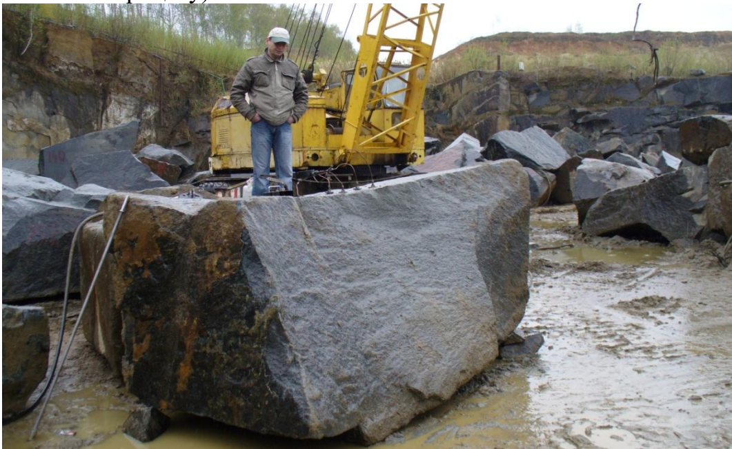
Рис. 4.24. Гранітний блок з вставленими агрегатами для розколювання монолітних об'єктів гідророзривом.
