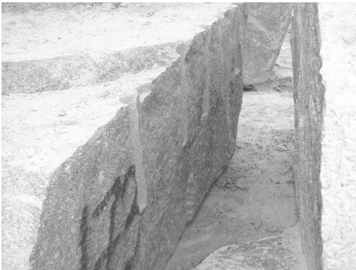
Рис. 4.15. Розколотий блок №1 (поверхня розколювання відповідає вимогам якості)
