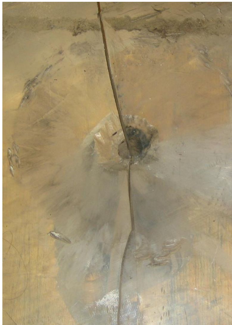
Рис. 5.8. Характер руйнування моделі з органічного скла вибухом циліндричного заряду з донною клиновидною вставкою
