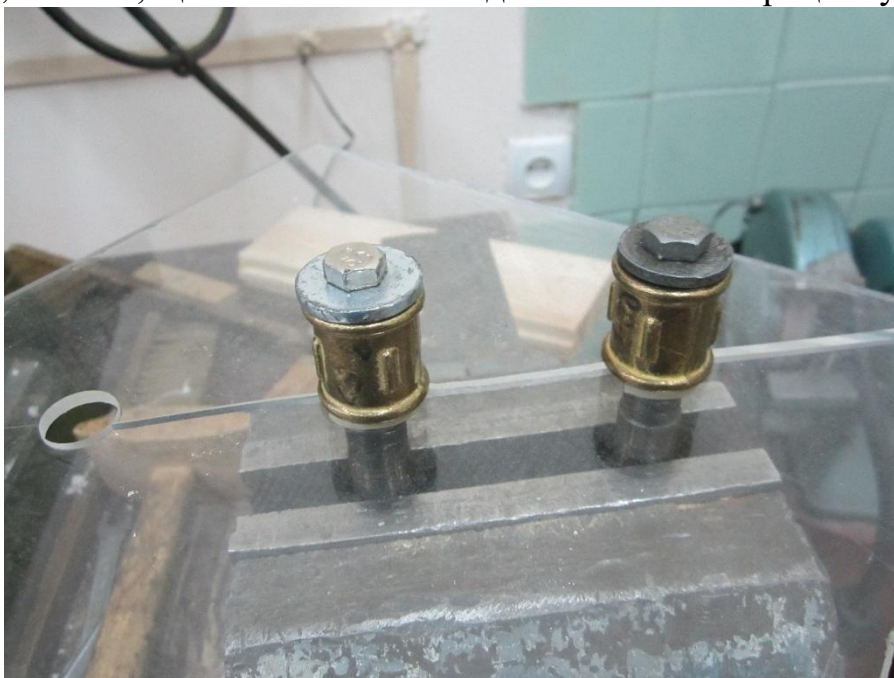
Рис. 4.7. Утворення тріщини по лінії запланованого відколювання.
