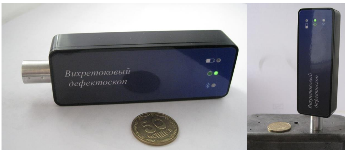
Рис 1. Мобільний вихрострумний дефектоскоп
