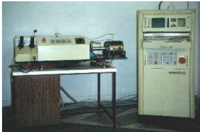
Рис. 1.5 – Серія комп'ютеризованих стендів ELMOTE XX для діагностики електродвигунів
