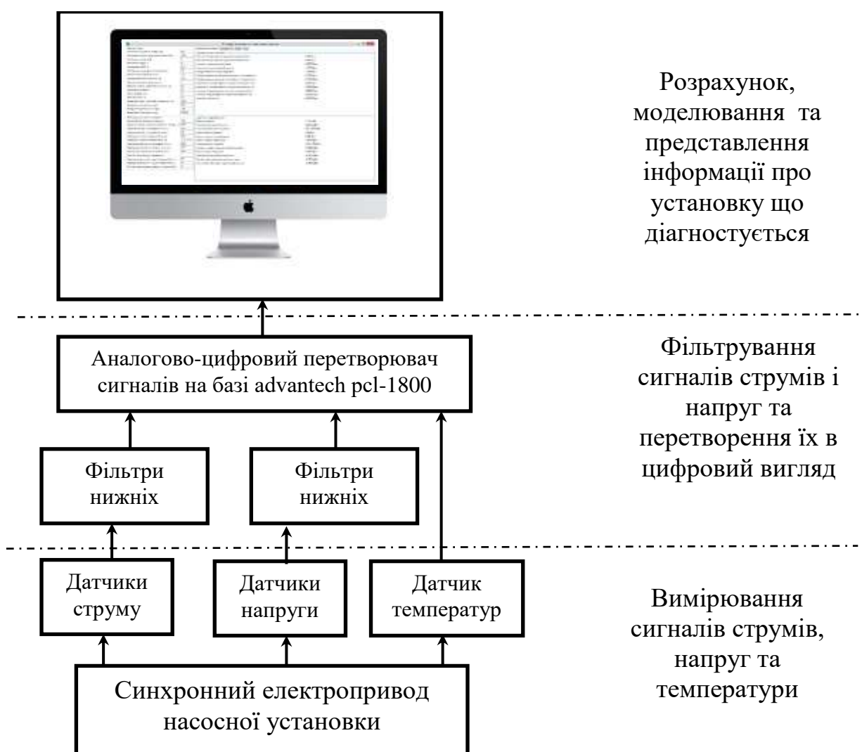
Рис. 4.7 Структурна схема мобільного комплексу для діагностування енергетичного та технічного стану ЕП НУ з СД
