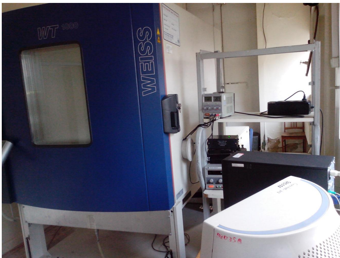
Рис. 4.8 – Камера для температурных испытаний WEISS1000
