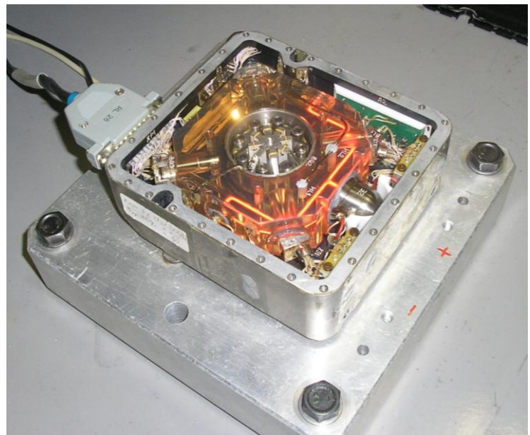
Рис. 3.1 – лабораторная установка для статических испытаний ЛГ
