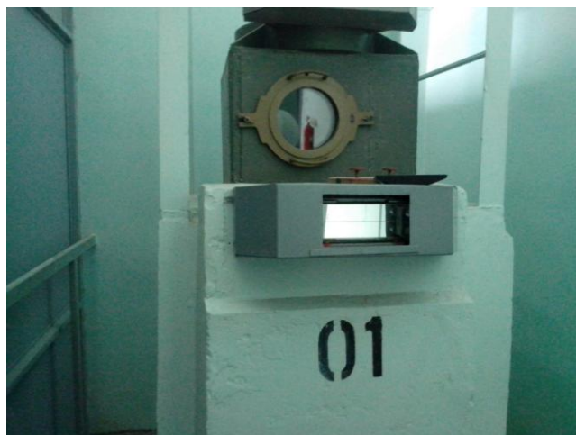
Рис. 5.2 – Жестко закрепленная призма для азимутальной оптической привязки изделий
