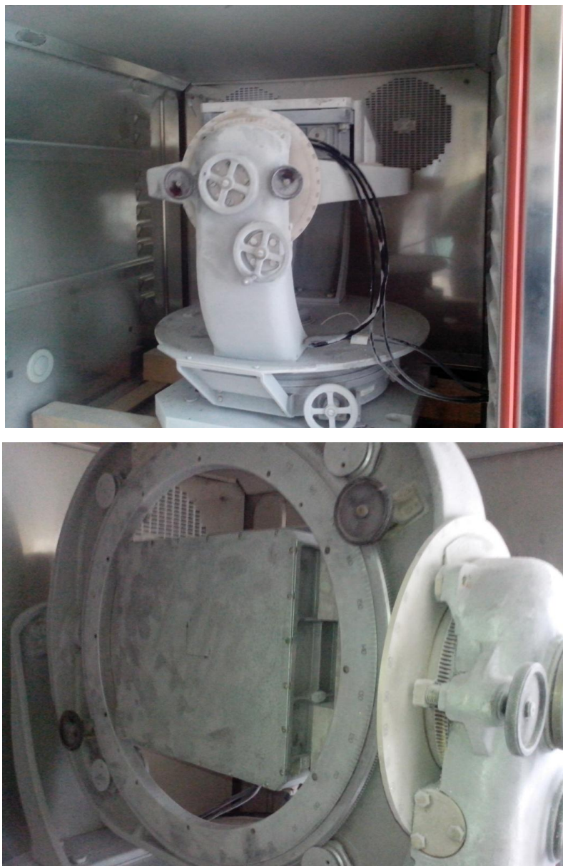
Рис. 4.9 – БИНС в термокамере на механическом поворотном стенде во время охлаждения
