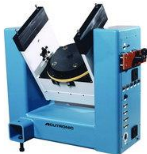
Рис. 1.1 – двухосный поворотный стенд производства Acutronic
