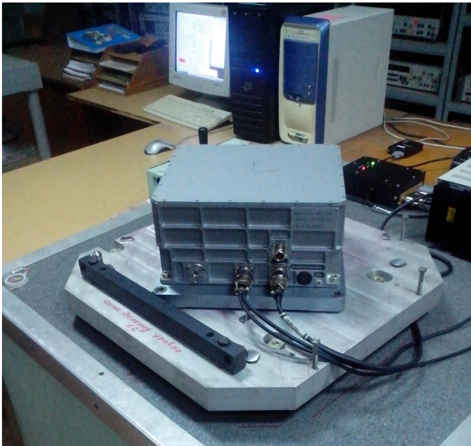
Рис. 4.1 –БИНС на рабочем месте для проведения статических испытаний
