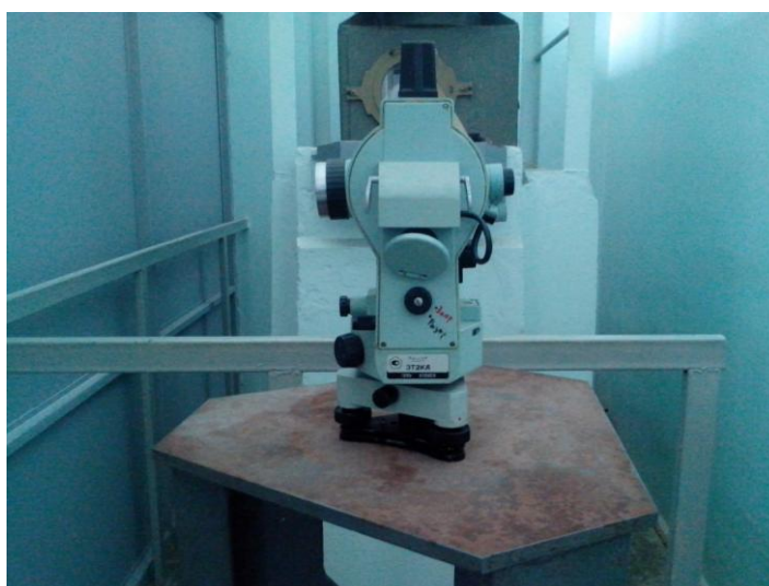
Рис. 5.3 – Процесс определения угла между оптическими элементами с помощью теодолита 2Т2А
