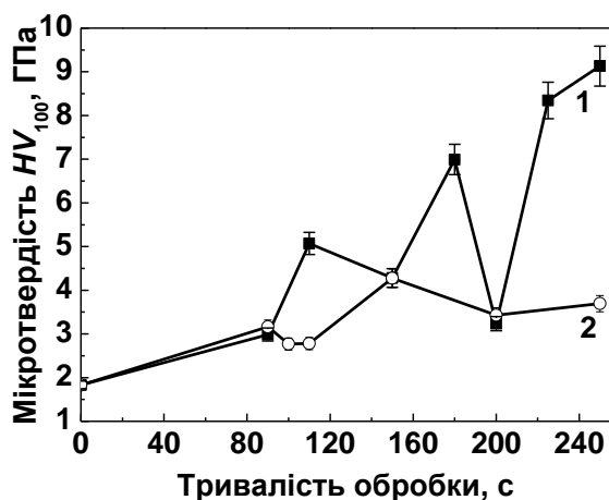
Рис. 2. Зміна мікротвердості поверхні зразка алюмінієвого сплаву Д16 після УЗУО: 1 – обробка на повітрі; 2 – обробка в інертному середовищі.
