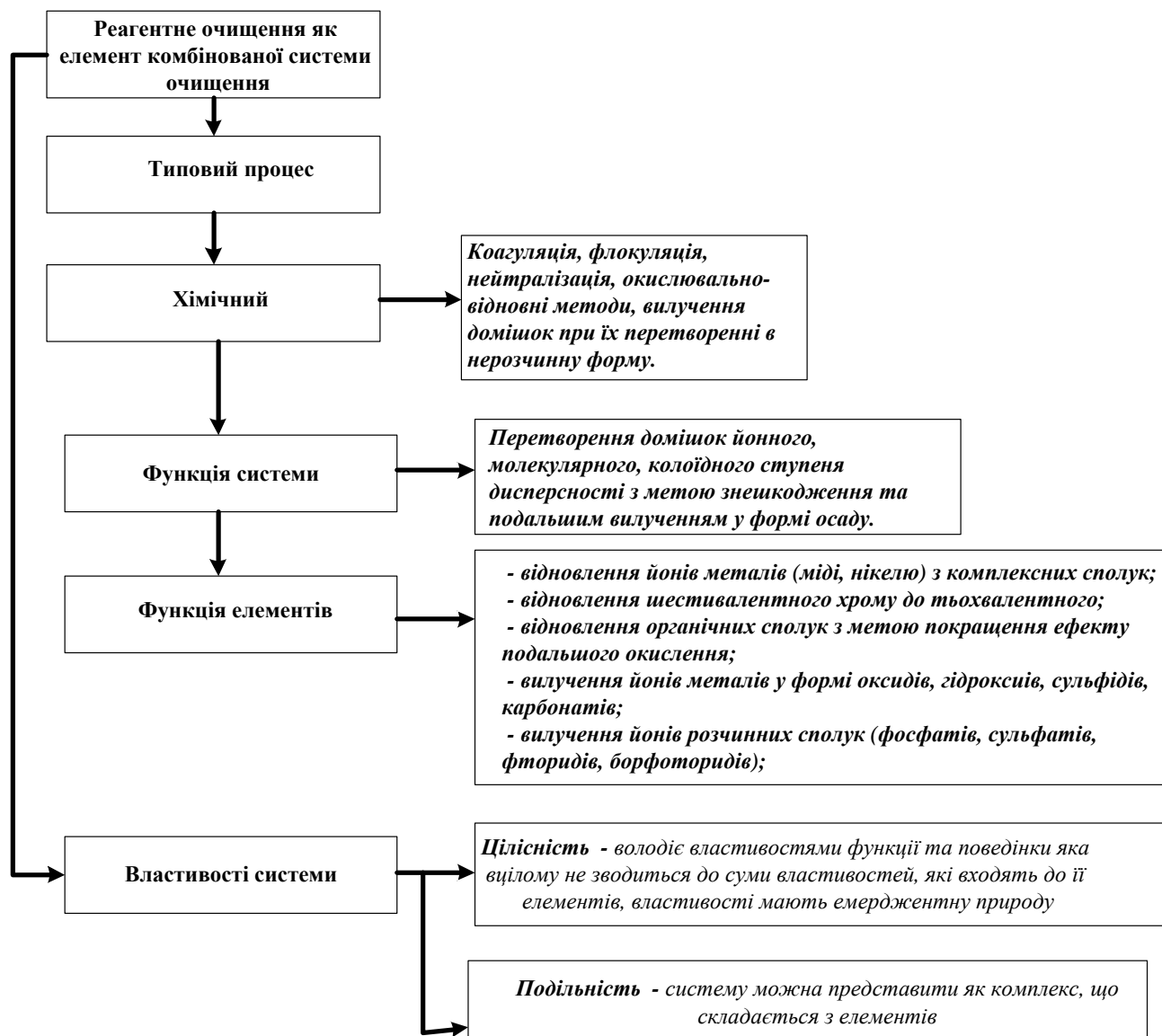
Рисунок 3.4 – Реагентне очищення як елемент комбінованої системи за методом QFD
