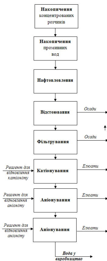
Рисунок 1.14 – Функціональна схема очищення концентрованих розчинів і промивних вод гальванічного виробництва
