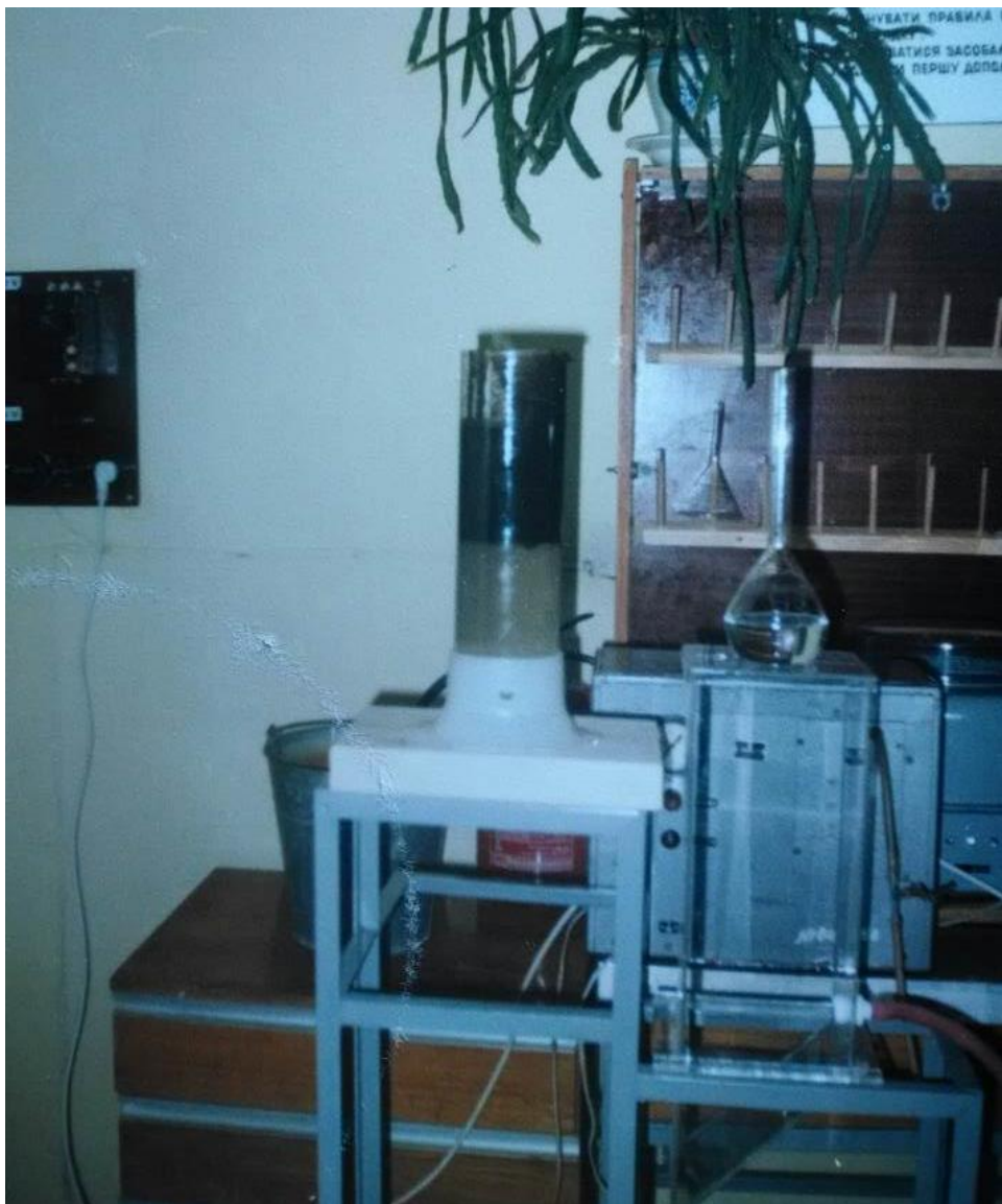
Рисунок 2.5 – Фото експериментально-лабораторної установки (блок йонообмінного доочищення)
