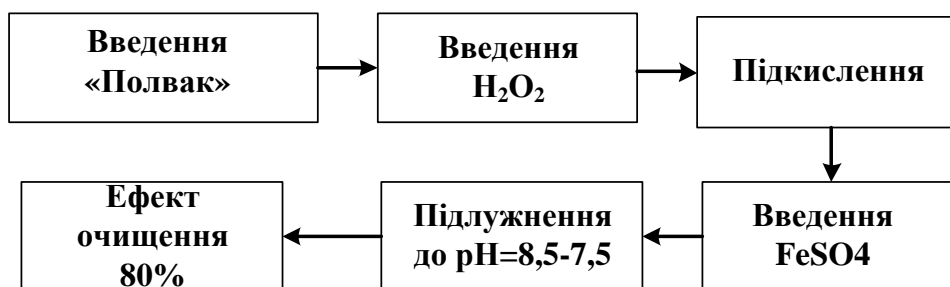
Рисунок 4.22 – Структурна схема досліджень другої серії (з використанням алюмінієвмісного коагулянту) очищення металовмісних лужних стічних вод після операцій підготовки поверхні від сполук органічного походження
