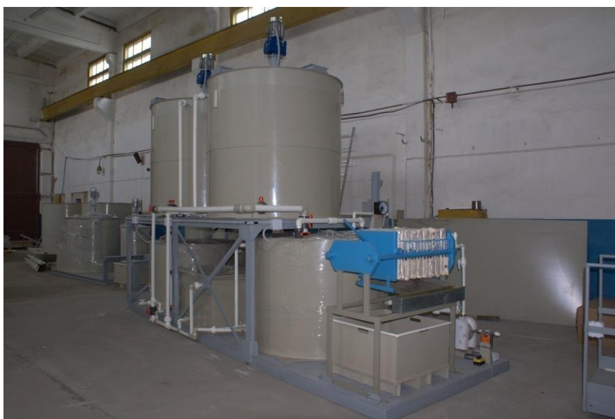
Рисунок 2.7 – Фото блоку локального очищення окремих категорій концентрованих стічних вод гальванічного виробництва ТзОВ «Завод метизних виробів»
