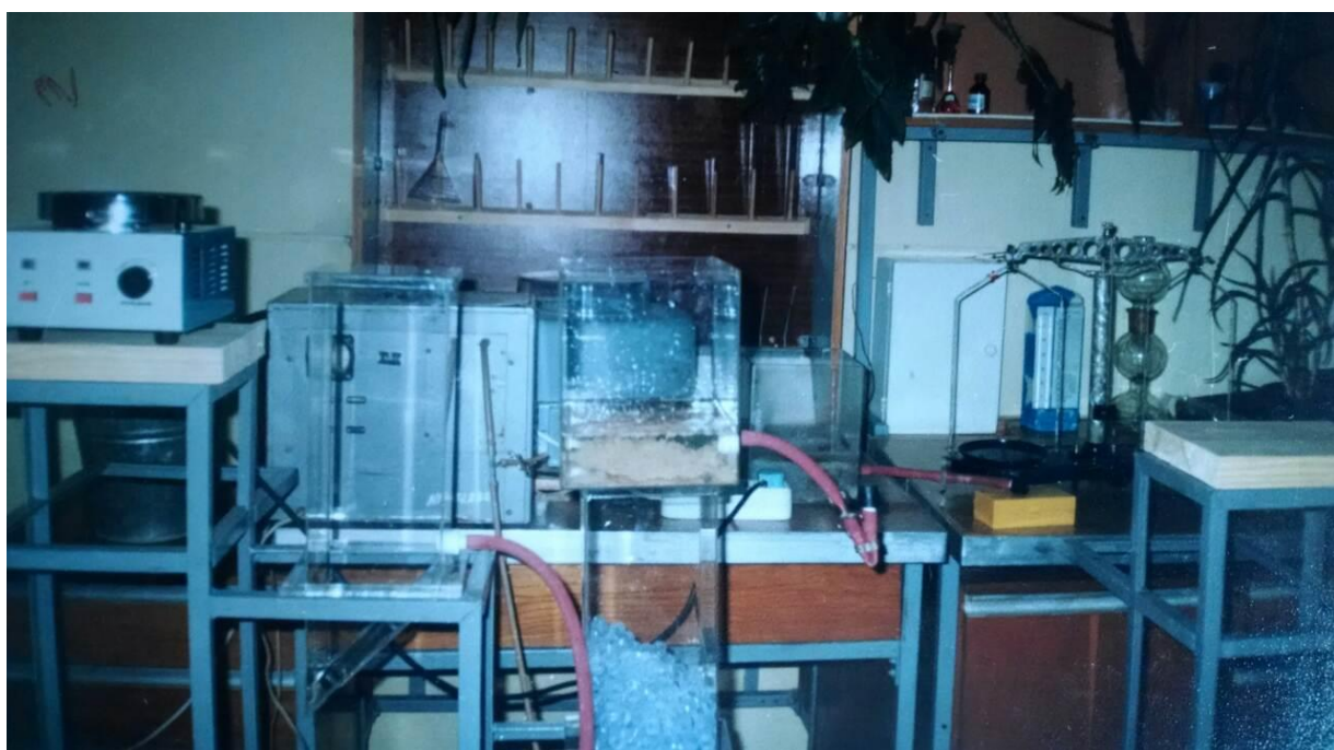
Рисунок 2.4 – Фото експериментально-лабораторної установки (блок реагентного очищення)
