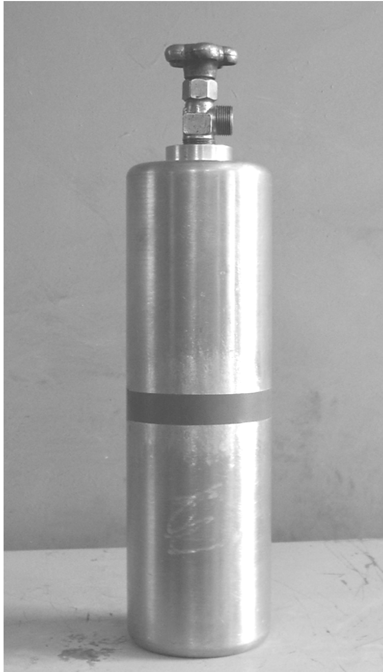
Загальний вигляд малогабаритного комбінованого балону зберігання газоподібного водню
