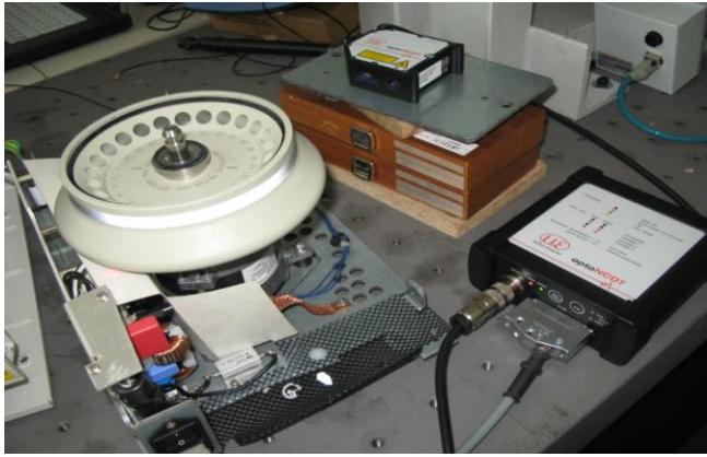
Рис.2.17. Стенд та його схематичне зображення для експериментального визначення залежності власних частот від частоти обертання
