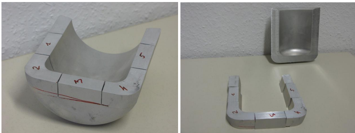
Рис.3.12 Схема розрізання чашки на елементи для випробування механічних властивостей матеріалу і дослідження макро- і мікроструктури:
