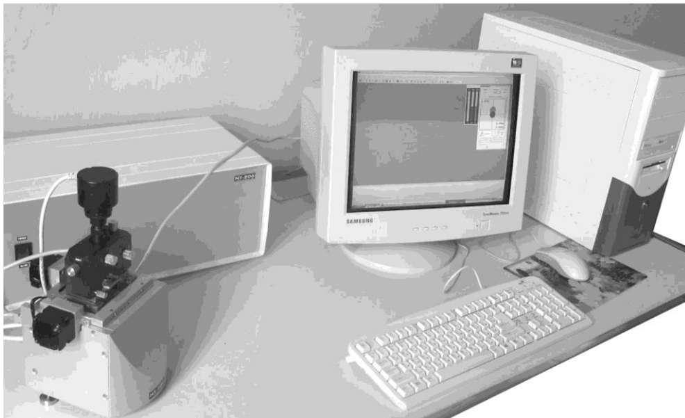
Рис. 2.1. Комплекс на базі атомно-силового мікроскопа “NT-206” для контролю лінійних розмірів і мікрорельєфу топології оптичних елементів.
