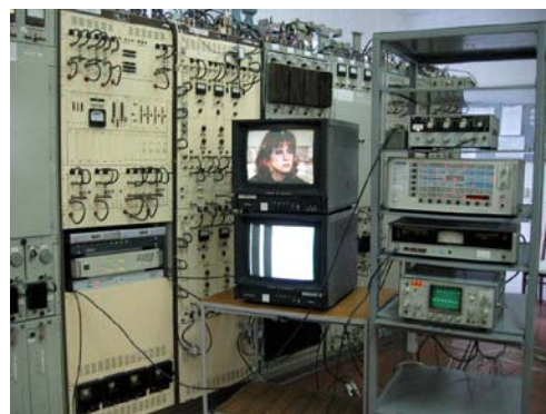
Передача телевізійних програм по радіорелейній лінії «Курс-4» із застосуванням інтегрованого формувача
