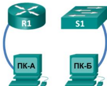
Рис.3.1. Мережа з комутатором та маршрутизатором, які підключені через консольний кабель до вузлів
