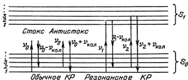
Рисунок 1.3 – Можливі енергетичні переходи в молекулі, непружного випромінювання, що взаємодіє з квантом світла
