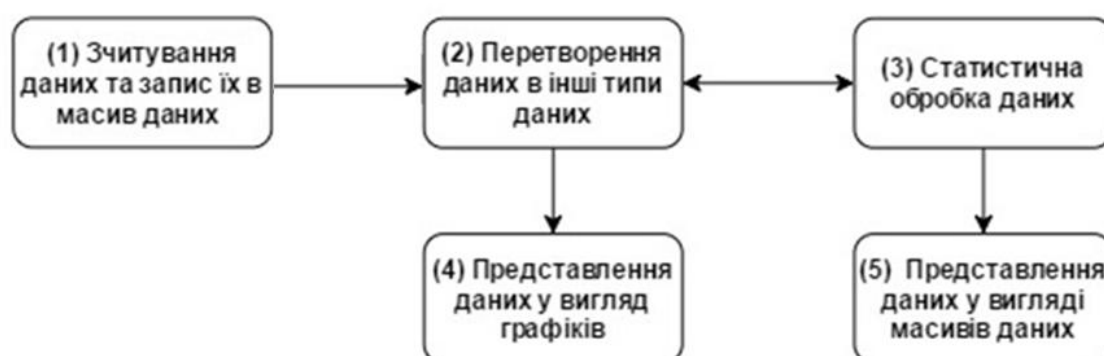
Рисунок 3.1 – Структурна схема комп'ютерної моделі обробки спекл – інтерферограм
