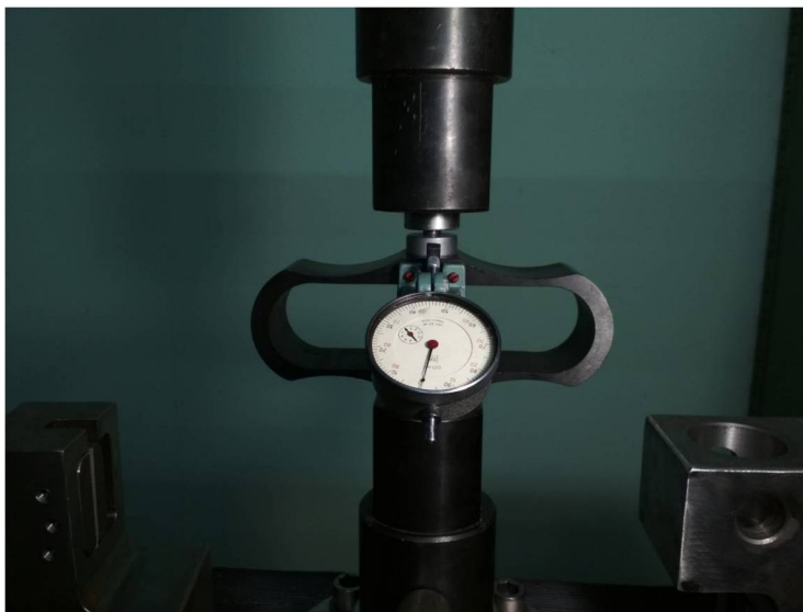
Рис.2.34. Тарування динамометру типу ДОСМ-3-1 на навантажувальному стенді TIRA TEST 2300.
