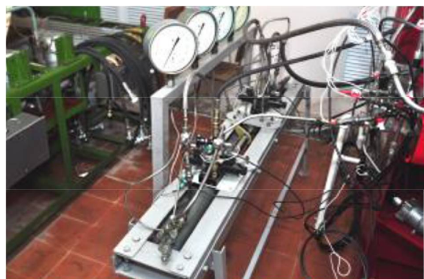
Рис. 1.10. Зовнішній вигляд стенда для проведення випробувань гідроприводу з дискретним регулятором потоку і інерційної трубкою (а) і навантажувального модуля (б). [12]
