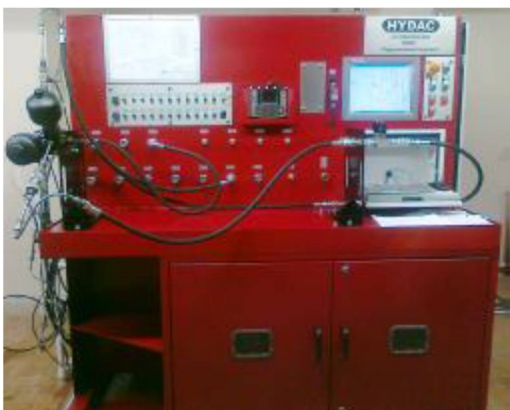
Рис. 1.10. Зовнішній вигляд стенда для проведення випробувань гідроприводу з дискретним регулятором потоку і інерційної трубкою (а) і навантажувального модуля (б). [12]
