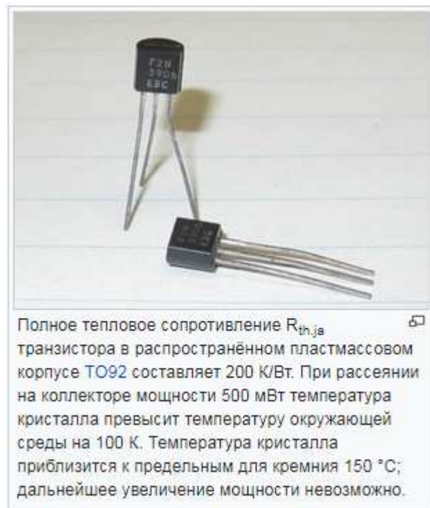
Рисунок 3.18 – Зображення з описом характеристик тепловіддачі корпусу TO-92
