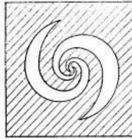
Рисунок 1.1.2.4 – Щілинна плоска логарифмічна спіральна антена
