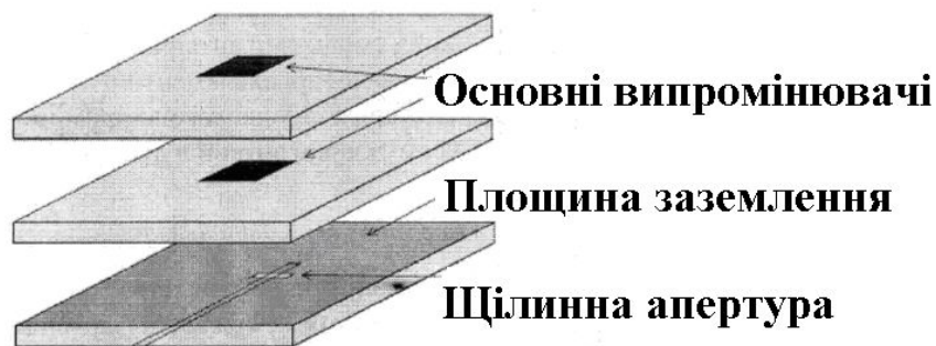
Рис. 1.2.4. Широкопосмуговий дворезонаторний смужковий випромінювач із живленням за допомогою щілинної апертури
