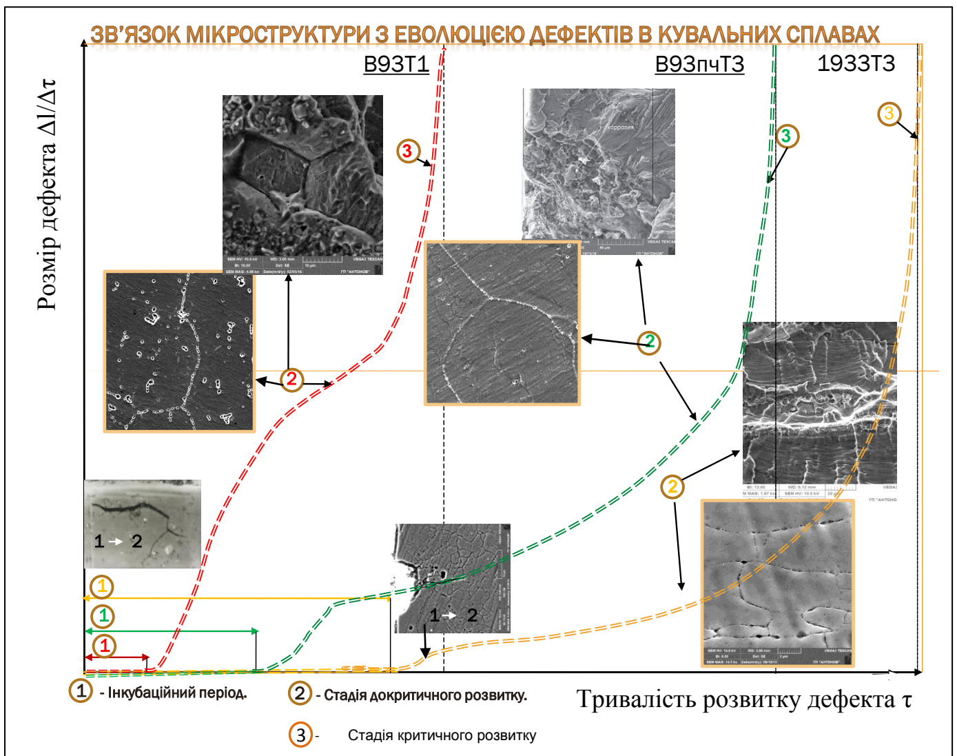
Рис. 3.21. Зв'язок мікроструктури з еволюцією дефектів в алюмінієвих кувальних сплавах.
