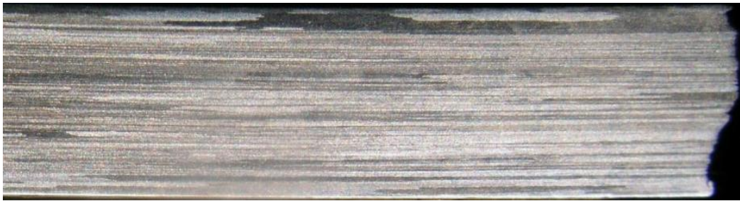
Рис. 1.2. Макроструктура сплаву B95T1 (пресована панель). Чітко видно видовжені волокна, розташовані у напрямку деформації.
