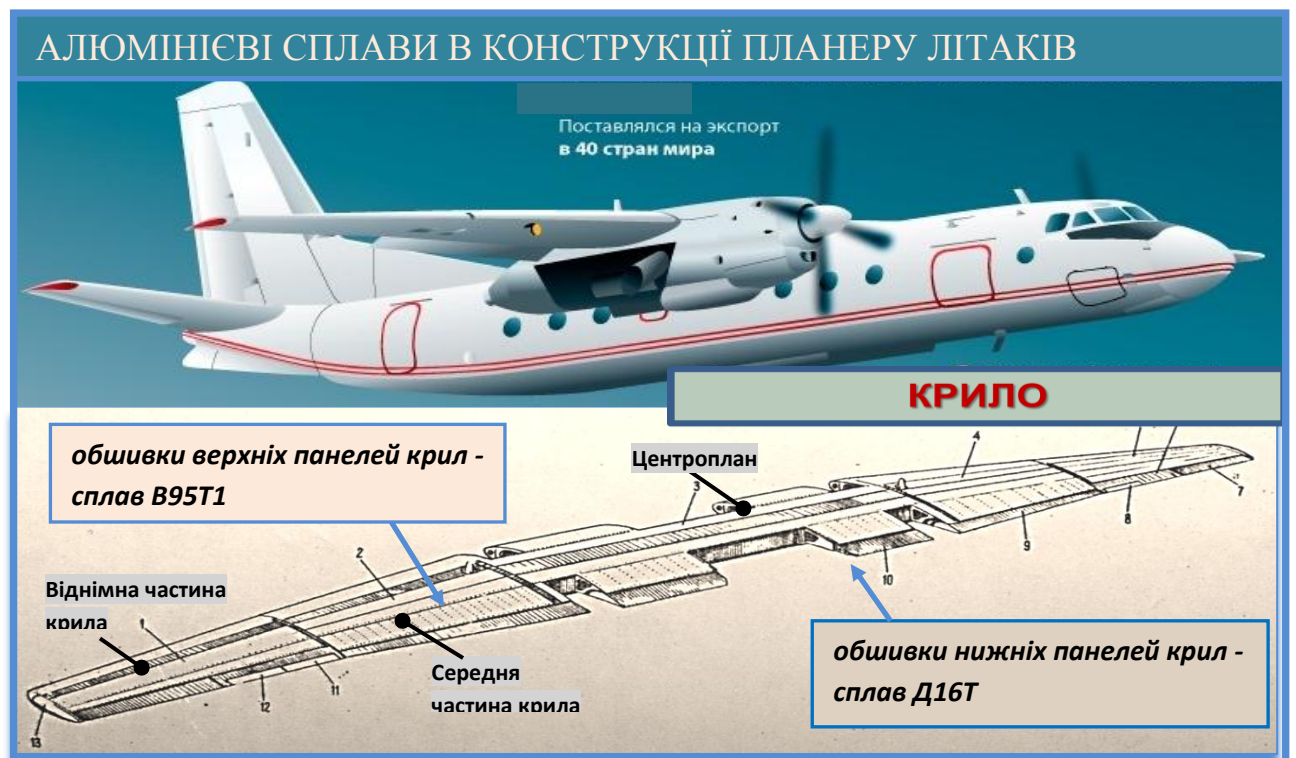
Рис. 1.1. Схема будови крила літака з вказівкою матеріалів, що застосовуються для обшивок верхніх та
