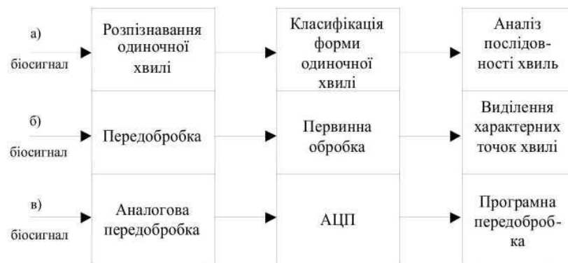
Рис. 2.3. Конвеєр класифікаторів для оперативної обробки біологічних сигналів: а) - загальна схема; б) - конвеєр для розпізнавання одиночної хвилі; в) - блок-схема попередньої обробки біосигналу
