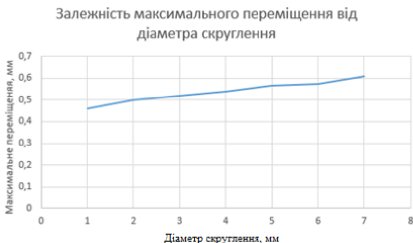
Рисунок 2.10 – Залежність максимального переміщення від радіусу скруглення паза 3
