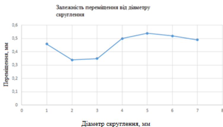
Рисунок 2.6 – Дослідження переміщення для першого паза
