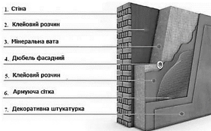
Рисунок 2.3 – Розріз конструкції зовнішніх стін із фасадною теплоізоляцією
