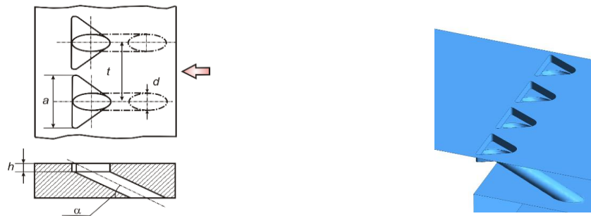
Рис. 2.6. Система плівкового охолодження: трикутні кратери [46]
