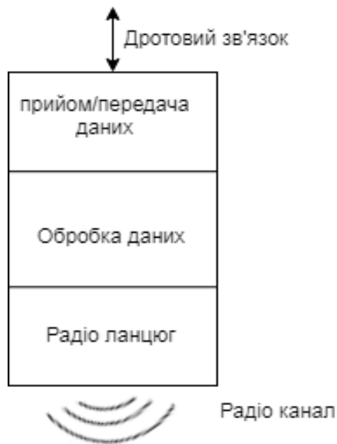
Рис. 5.2. Схема внутрішньої будови МБЗ
