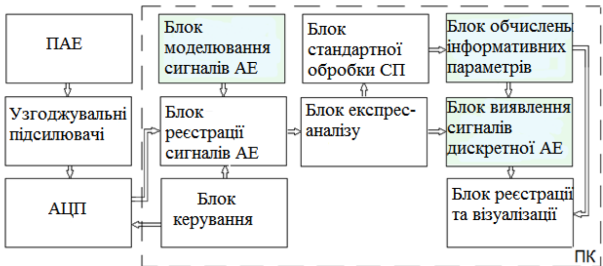
Рис. 3.1. Структурна схема безпорогового пристрою для виявлення сигналів АЕ
