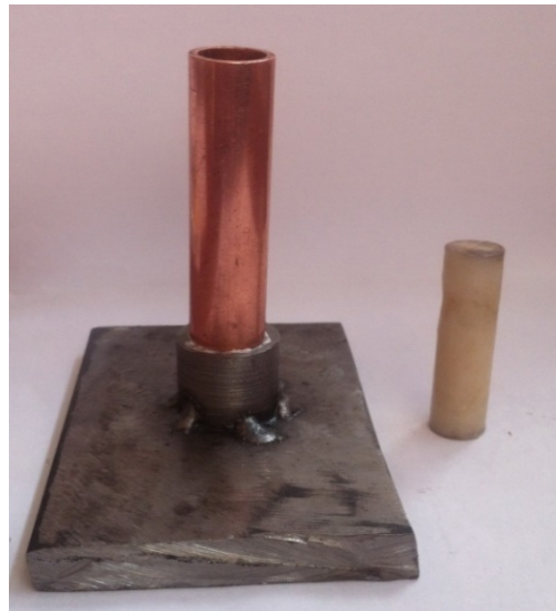
Рисунок 2.1.1 – Парафіновий стрижень з нанопорошком і пристрій для його виготовлення.
