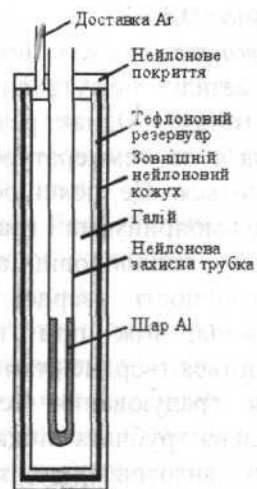
Рис.2.6. Конструкція приладу для отримання точки топлення галію
