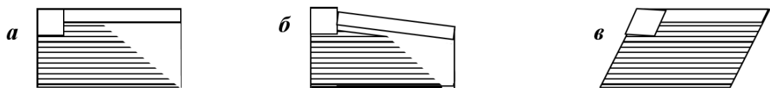
Рис. 3.20 – Форми дек концентраційних столів. а – прямокутна; б – трапецієвидна; в – діагональна
