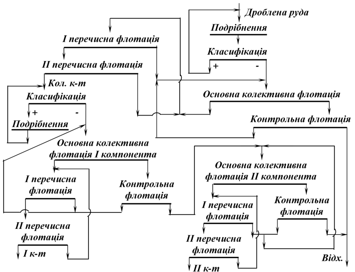
Рис. 3.50 – Схема флотації двокомпонентної руди
