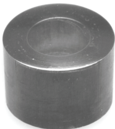
Рис. 7. Фото детали «заглушка», полученной из пористой медной заготовки
