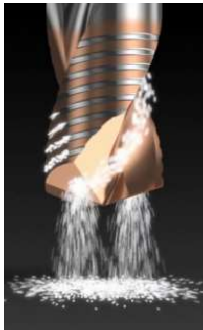
Рис 1.5.2 – свердло з внутрішніми каналами під ЗОР.
