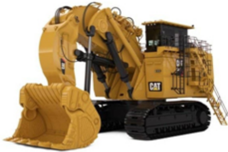
Рис. 3.14. Гідравлічний екскаватор з робочим обладнанням прямої (а) і зворотної (б) лопати
