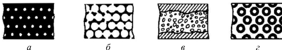
Рис. 5.57. Типи структур газовмісних полімерів: а – закритопориста, б – відкритопориста; в – інтегральна; г – синтактна (з порожнистим наповнювачем)
