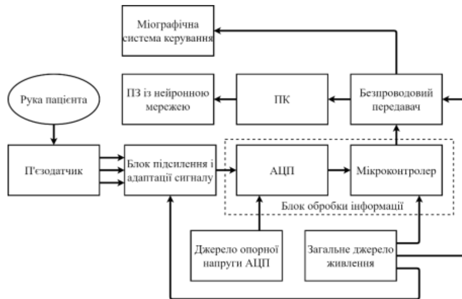
Рисунок 3.5 Структурна схема модуля для вимірювання FMG сигналу
