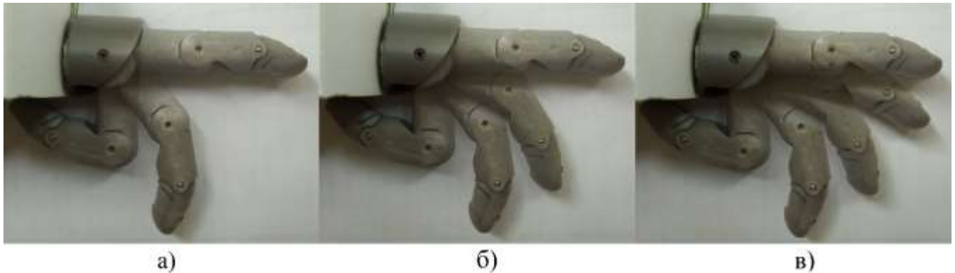
Рисунок 4.23 Процес руху біонічного пальця у різних швидкісних режимах: «швидкий» режим (а); «середній» режим (б); «повільний» режим (в); «нерухомий» режим – не показано
