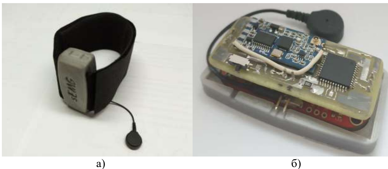
Рисунок 3.3 Загальний вигляд прототипу sEMG модуля. Конструкція модуля у зібраному (а) стані та без кришки (б)
