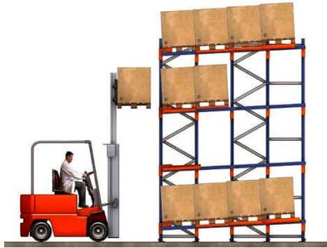
Рис.7.8. Схема палетного стелажу Push Back
