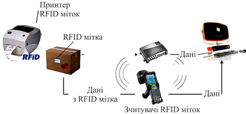
Рис. 8.3. Радіочастотна ідентифікація (RFID)
