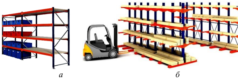
Рис. 7.10. Поличковий (а) і консольний (б) стелажі
