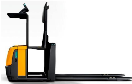
Рис. 7.18. Комплектувальник замовлень: a – низькорівневий; б – високорівневий
