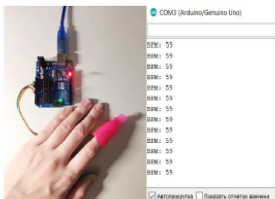
Рисунок 5. Кріплення датчику до пальця та результат вимірювання частоти серцевих скорочень.
