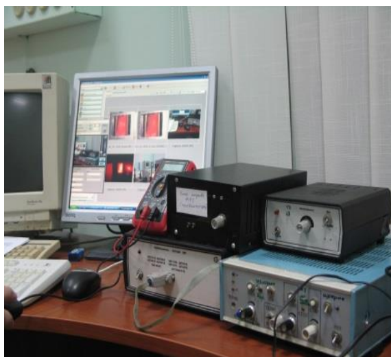
Рис.3.1. Загальний вигляд апаратури реєстрації оптичних голограм: а – коретка із зразком, б – блоки керування процесом створення темплату
