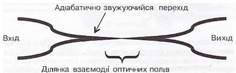
Рис. 1.14. Схематичне зображення волоконно-оптичного відгалужувача типу 2 \times 2 на базі сплавного звужувального переходу
