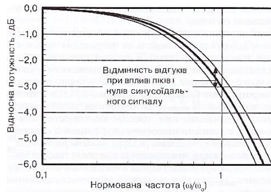
Рис. 4.31. Нормована АЧХ однополюсного RC-фільтра (напівжирна крива в центрі) та АЧХ цього ж фільтра в разі невеликого збільшення (нижня крива) або зменшення (верхня крива) ємності
