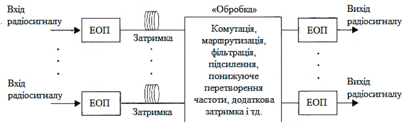
Рис. 1.1. Узагальнена функціональна схема багатоканальної ВОСП
