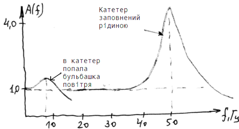
Рис. 41 – Типова амплітудно-частотна характеристика катетерів для екстракардіоваскулярного методу вимірювання тиску крові.
