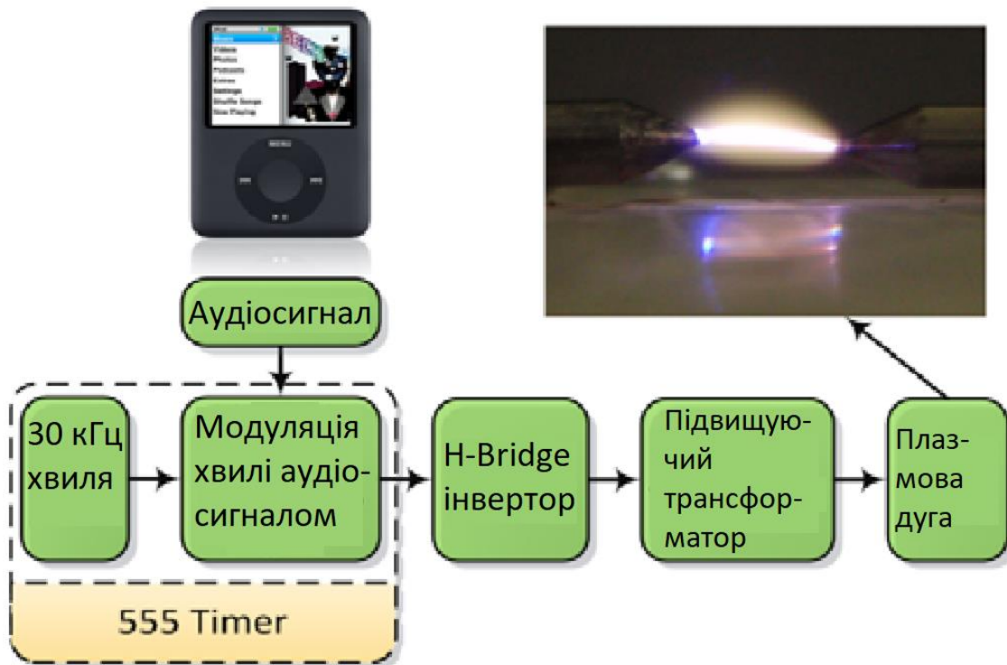
Рисунок 4.14. Блок схема іонофона
