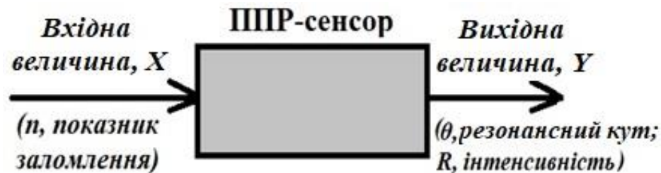
Рис. 1.3.1. Схема перетворення для ППР-сенсора з кутовим скануванням
