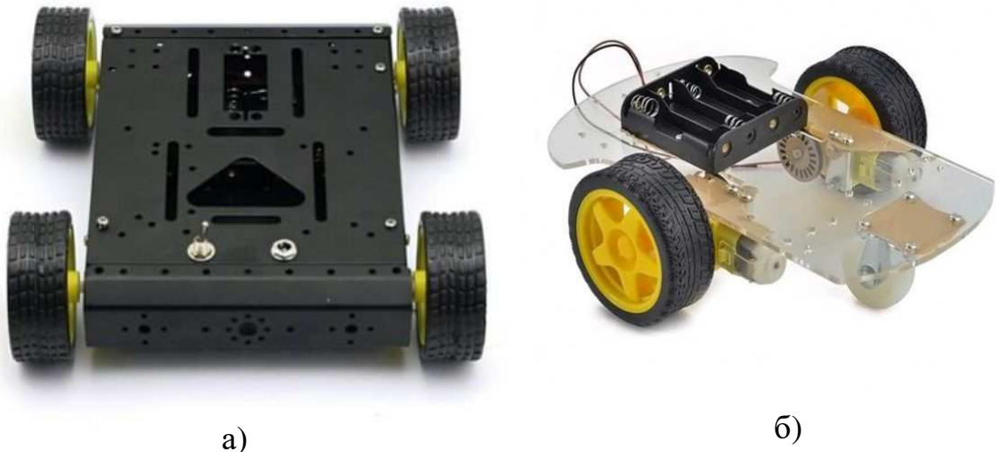
Рис. 1.1. Шасі на колісному рушії: а) повнопривідне; б) однопривідне.
