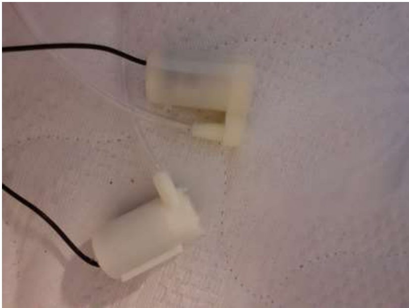
Рис.2.21 Приєднання трубок до pomp
