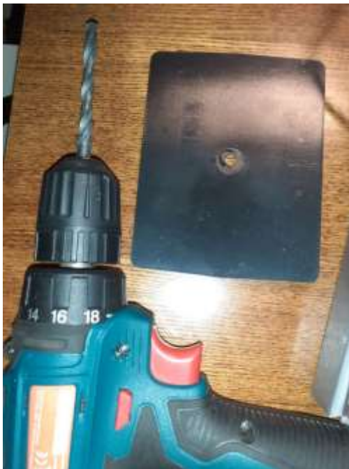
Рис.2.23 Виготовлення технологічних отворів
