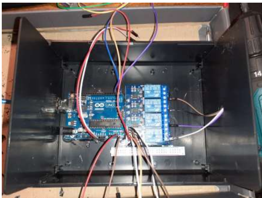
Рис. 2.24 Закріплення контролера, блока реле та макетної плати у нижню частину корпусу
